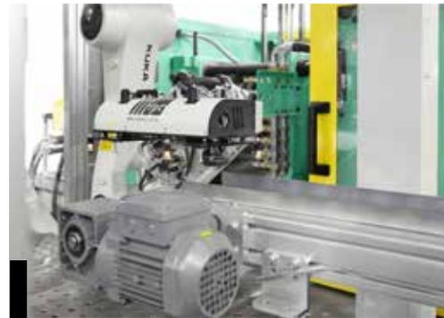
Système de convoyage sur les machines à injecter le plastique
